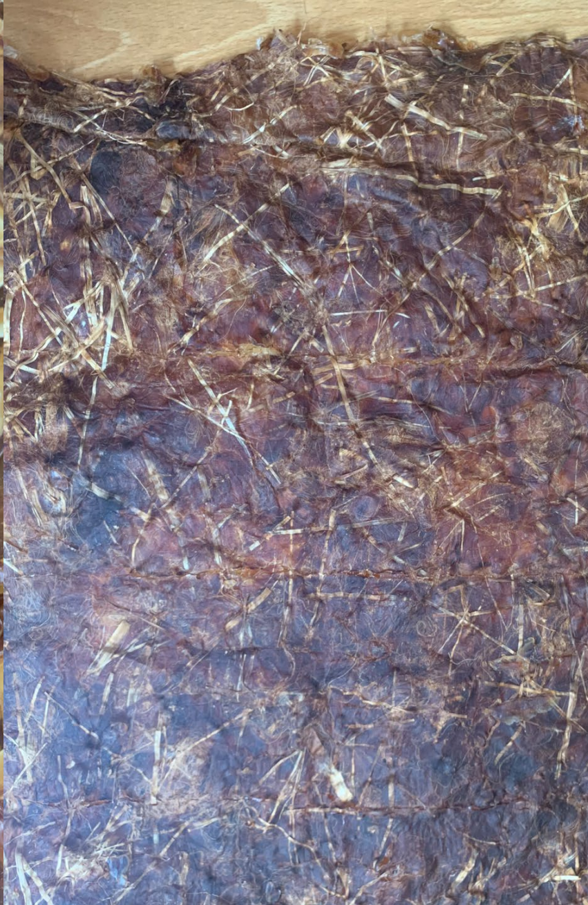
Komplette Spargelabfälle gehäckselt + Latex
