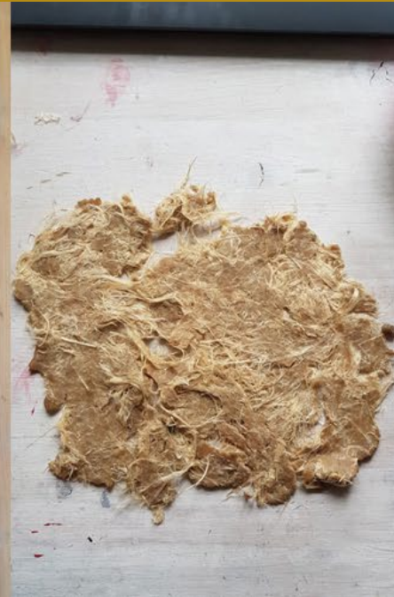
getrocknete Spargel- Glutenmasse
